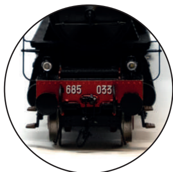
Fanali elettrici funzionanti e respingenti a bovolo
